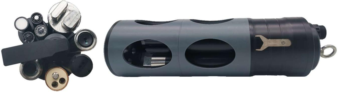
BSM-2可测量的参数<sub>1</sub>: 水温, pH, ORP, 溶解氧, 浊度(悬浮物, 透明度), 电导率(TDS/盐度), COD TOC BOD, 氨氮, 叶绿素a, 蓝绿藻, CDOM, 水中油。
